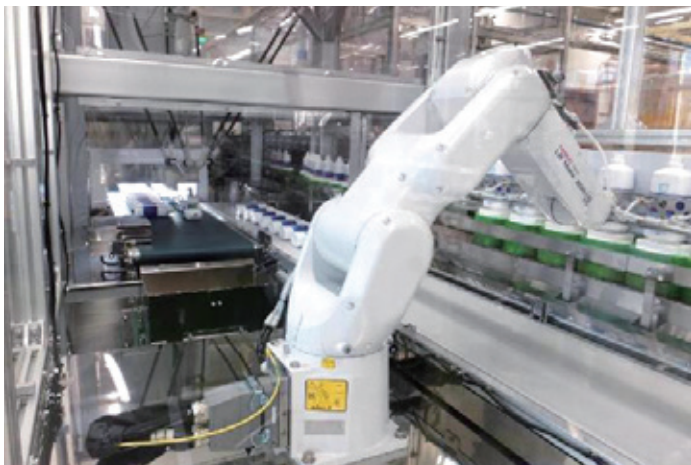
ロボット活用によるデンタルリンスボトル供給の自動化
