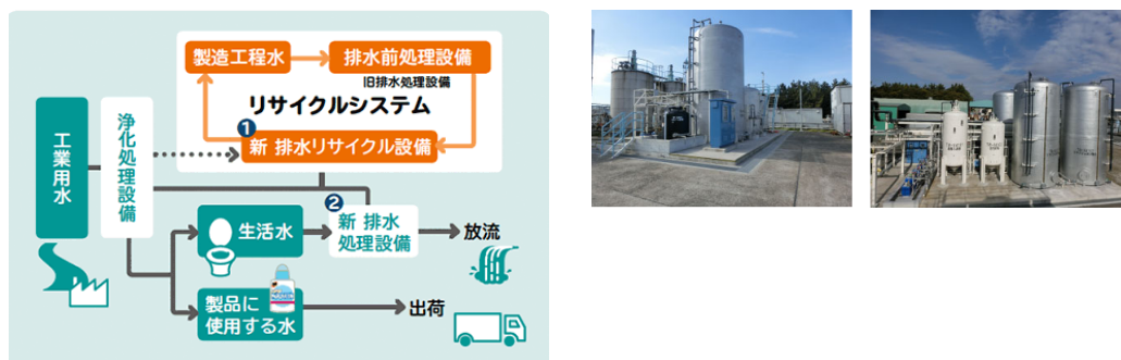
千葉工場の排水リサイクルシステム
