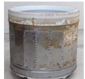
洗濯槽の裏側の汚れ
