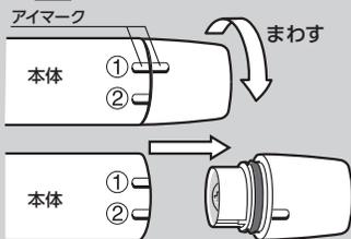
2: 本体のスイッチOFFボタンを押し、スイッチがOFFであることを確認してから単4アルカリ乾電池を図のように本体にいれます。
