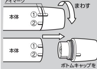
2:本体のスイッチOFFボタンを押し、スイッチがOFFであることを確認してから単4アルカリ乾電池を図のように本体にいれます。
